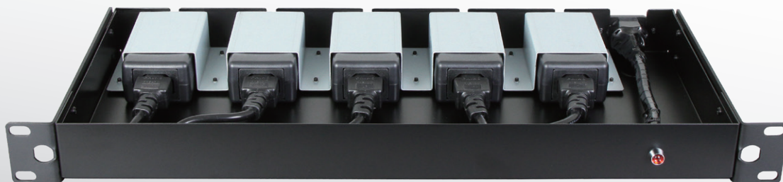
※ MPC-100 及接收機電源供應器組裝完成圖
